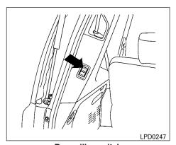
Rear pillar switch OPERATING THE POWER LIFT GATE (if so equipped)
